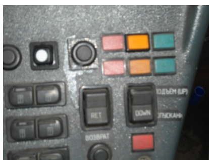
Рис. 1. Панель приборов автобуса ЛиАЗ-52937. Индикаторы (лампы) утечки газа (две жёлтые лампы в среднем вертикальном ряду), кнопка переключения режима работы газовых баллонов (с белым кружком), индикаторы (лампы) включения газовых баллонов (две зеленые лампы), кнопка диагностики исправности СУГ (между кнопкой переключения режима работы газовых баллонов и красными индикаторами исправности двигателя)
