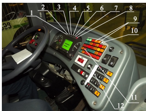
Рис. 1. Панель приборов автобуса ЛиАЗ-52937. Индикаторы (лампы) утечки газа (две жёлтые лампы в среднем вертикальном ряду), кнопка переключения режима работы газовых баллонов (с белым кружком), индикаторы (лампы) включения газовых баллонов (две зеленые лампы), кнопка диагностики исправности СУГ (между кнопкой переключения режима работы газовых баллонов и красными индикаторами исправности двигателя)
